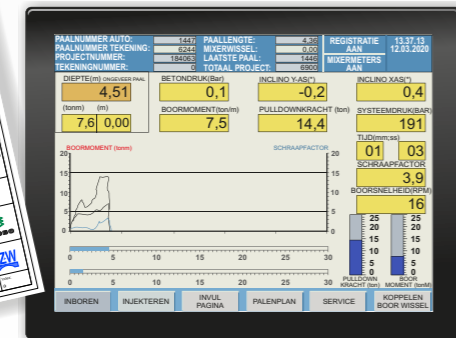
Bohrdatenanzeige gewährleistet kontrolliertes Abbohren und Betonieren
